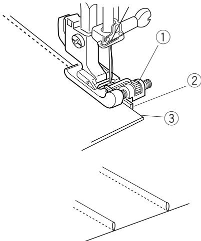
Сложите ткань лицевой стороной вовнутрь. Опустите иглу на 0.1 - 0.2 см в сложенный край. Опустите лапку. Поверните винт на лапке так, чтобы направитель лапки примыкал вплотную к сложенному краю. Строчите медленно, направляя сложенный край вдоль направителя на лапке. Раскройте ткань и прогладьте складки.
