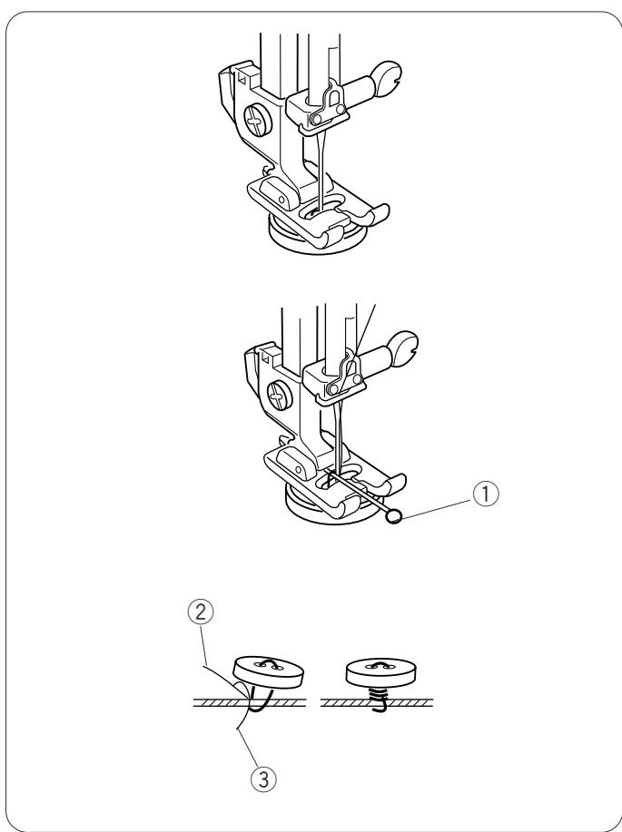
Удалите нить из иглы. Измените ширину зигзага так, чтобы игла сквозь прорезь на лапке попадала в отверстия пуговицы. Поверните маховое колесо и проверьте, входит ли игла в отверстия пуговицы. Опустите прижимную лапку, чтобы закрепить пуговицу на месте.
