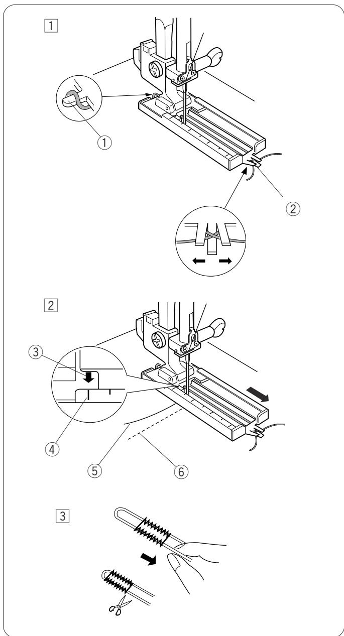
① Поднимите лапку для автоматической петли, набросьте шнур на крючок сзади лапки. Переведите концы шнура вперед, заправив под лапку.
