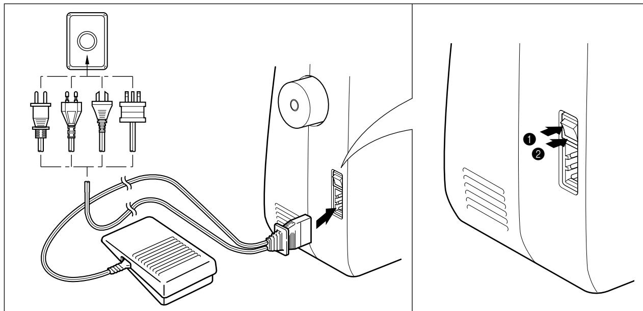
1. Вставьте трехконтактный разъем сетевого шнура в гнездо на машине.
